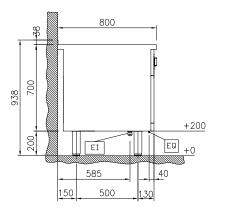
Electrical inlet (power) Equipotential screw
